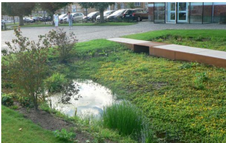
Figur 17. Exempelbild på hur en broliknande övergång i en yta som används till dagvattenhantering kan se ut. Foto: Ramböll
