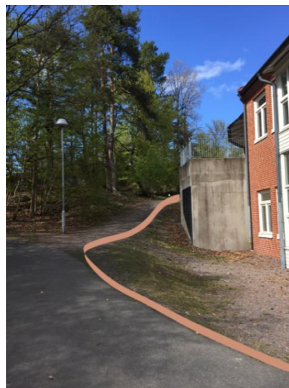
Figur 21 (vänster). Exempel avskärande åtgärd i form av kantsten placerad i parkering ovan innergården i den nordöstra delen av planområdet.
